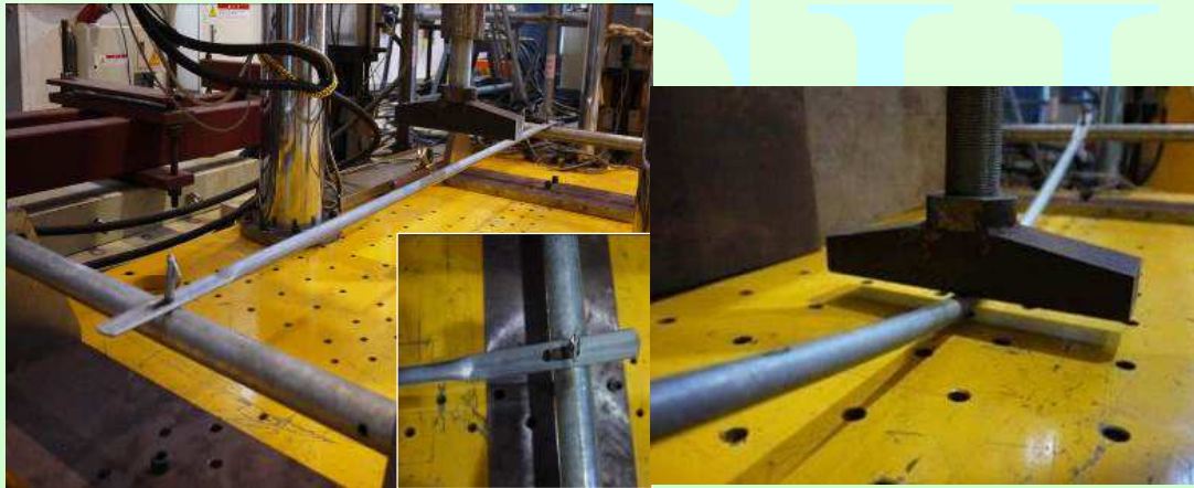
下拉桿測試裝置圖示
