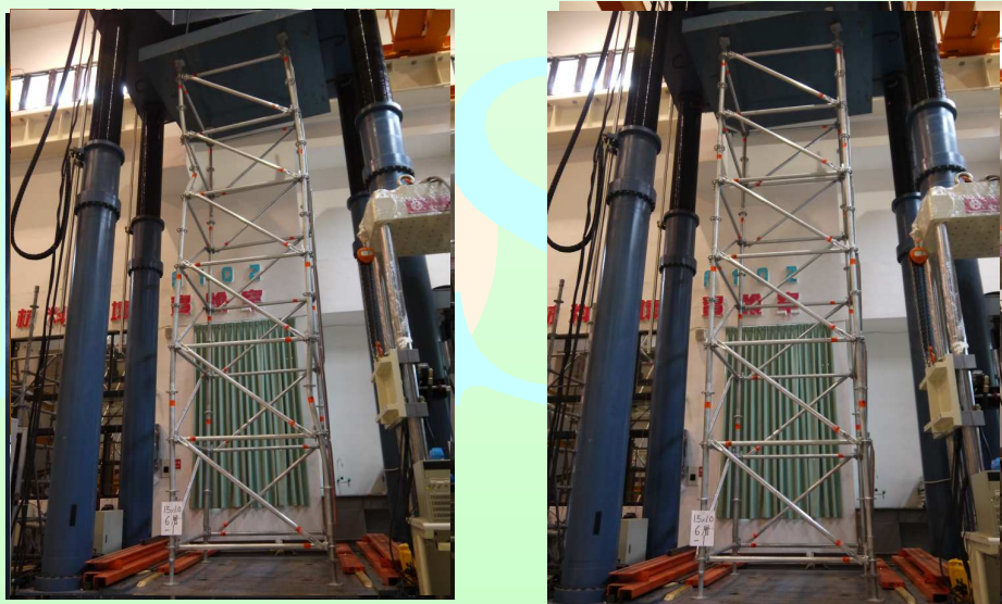
四層、五層及六層支撐架測試前後照片
