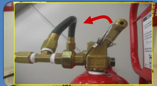
輪架式滅火器操作法
