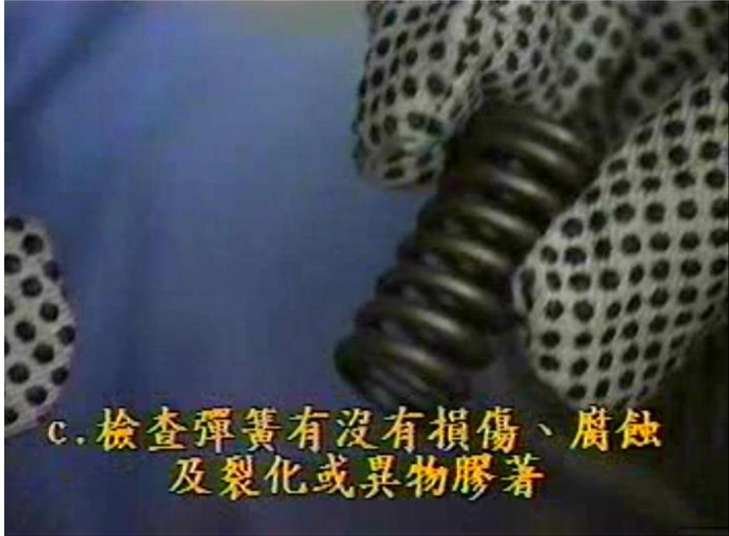
c. 檢查彈簧有沒有損傷、腐蝕
