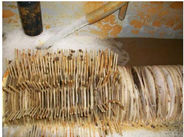
照片 2 第一階段薄膜刮除及反洗共用情形
