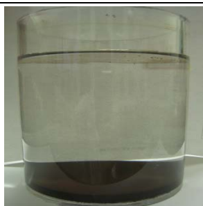
圖 16 磁種 2.49 g/L 及 PAC 0.01g/L 凝絮後水樣之影像
