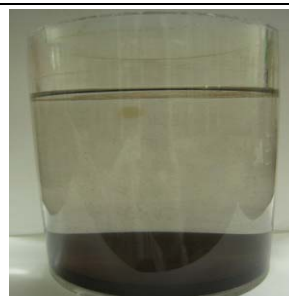
圖 17 磁種 1.24 g/L 及 PAC 0.01g/L 凝絮後水樣之影像
