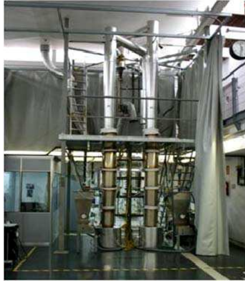
圖 2 INCAR-CSIC CaO Looping 實驗廠相片(30kW)
